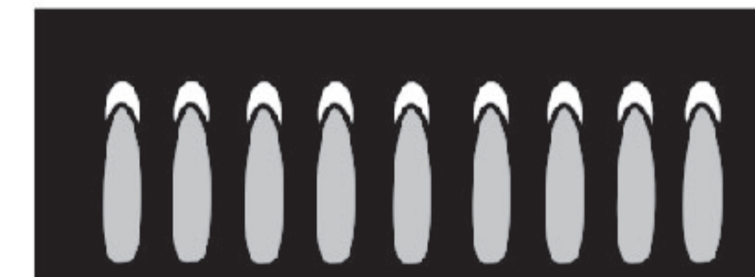
(B) 火焰外錐上有黃色火焰尖端— 丙烷氣正常
