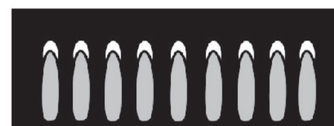
(B) 火焰外錐上有黃色火焰尖端— 丙烷氣正常
