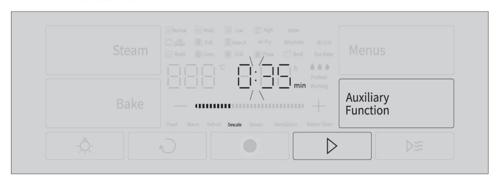
4. 除垢完成。工作完成后,倒計時歸零,蜂鳴10聲。
