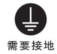
插座必須具有可靠的接地綫,以確保 安全。不得將接地綫接于煤氣管、自來 水管、避雷針及電話綫上。接地不良將 可能引發觸電或者其它意外事故。
