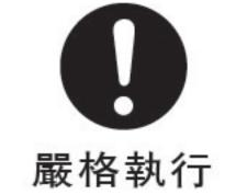
出現异常現象時,按電源鍵,關閉 烹飪機, 并拔下電源插頭或者切斷 總電源,馬上致電方太幸福服務熱 綫。异常狀態下連續運轉易發生觸電、 火灾等危險。
