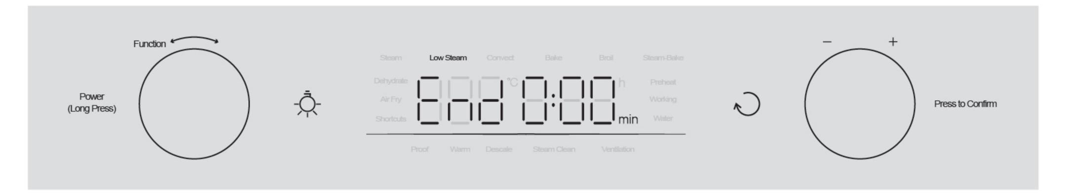
注: 预热及烹饪过程中,旋转旋钮可修改烹饪温度和烹饪时间。中间间隔10 秒无操作,则返回到原工作界面。 烹饪完成后,2min无操作自动关机。
