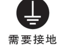
插座必须具有可靠的接地线,以确保 安全。不得将接地线接于煤气管、自来 水管、避雷针及电话线上。接地不良将 可能引发触电或者其它意外事故。
