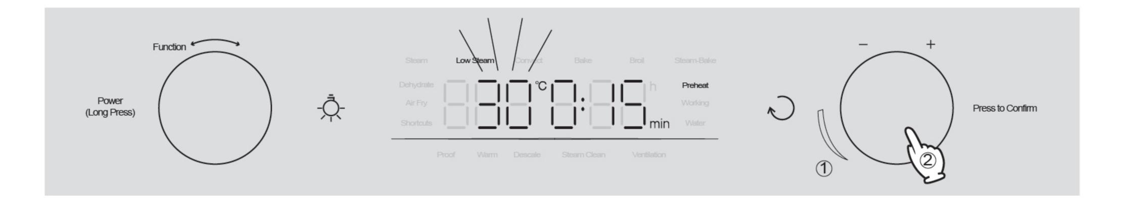
2. 修改时间参数。旋转旋钮2,即可修改时间参数,短按旋钮2确认修改。
