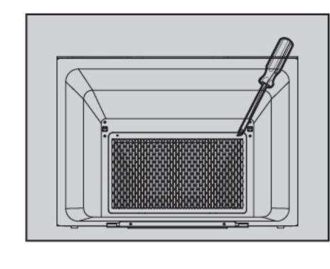
8.用左手拖住油網, 右手用十字螺絲刀 打開固定油網的兩 顆螺釘,取下油網。
