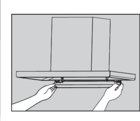
7.用雙手拖住油杯兩端,保持水平向正面移出倒去積油,將油 杯、整流板放入加有杯、整流板放入加有中性洗滌劑的温水中浸泡,用軟刷進行清潔。
