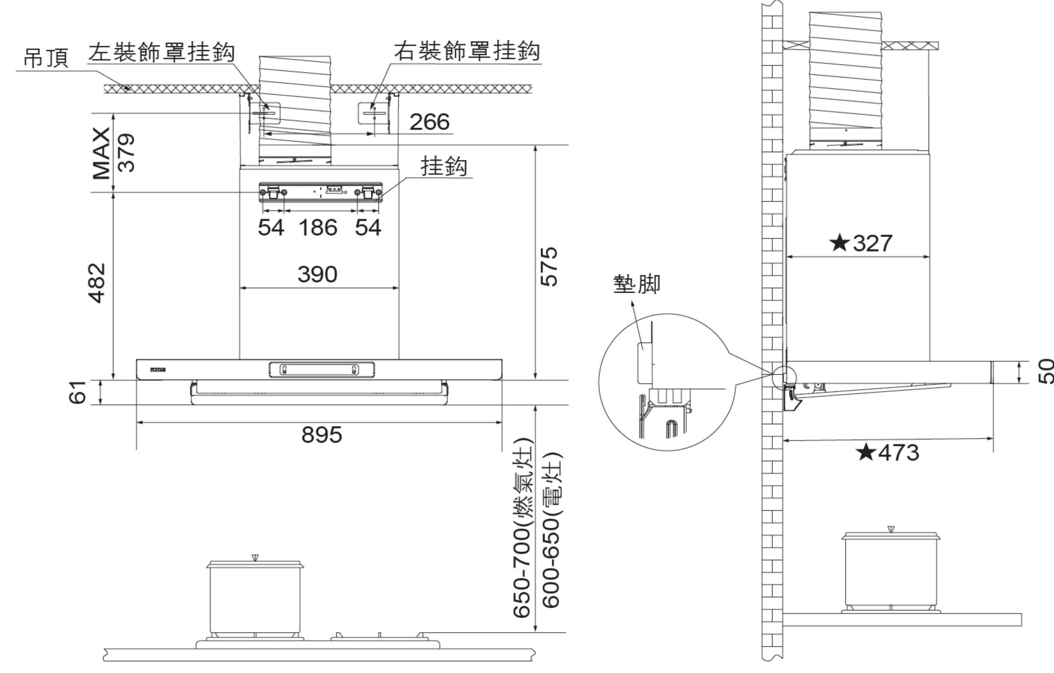
EMG9063-G 安裝示意圖 (★表示到墻的距離)
