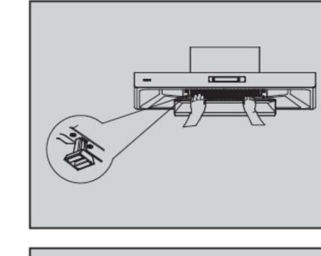
6.首先,用雙手抓住 蝶翼板前沿,向下 翻轉,使蝶翼向下 爪脱離,然后下 翻轉一定角度,最 后雙手平端着蝶翼 板向外取出。
