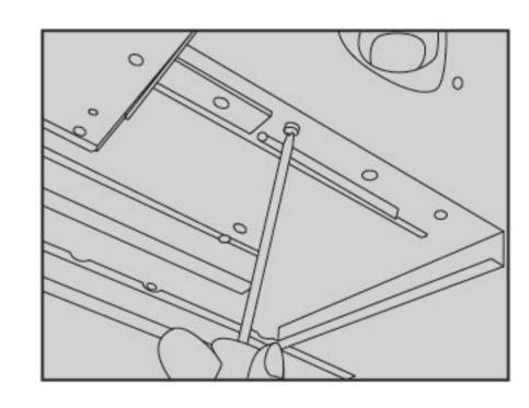
10.使用十字螺絲刀旋出風機架上的五顆螺釘(左右各一顆,圖16;頂部三顆),旋出左右兩側的四顆螺釘,旋出風機外罩上的螺釘,然后卸下風機蓋板。
