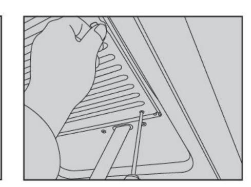
7.第一,按下拆卸和清洗鍵將 蝶翼板降低至最低位置,然 后雙手抓住蝶翼板前緣使其 向下翻轉,使蝶翼板卡扣脱 離,然后再次向下翻轉一定
