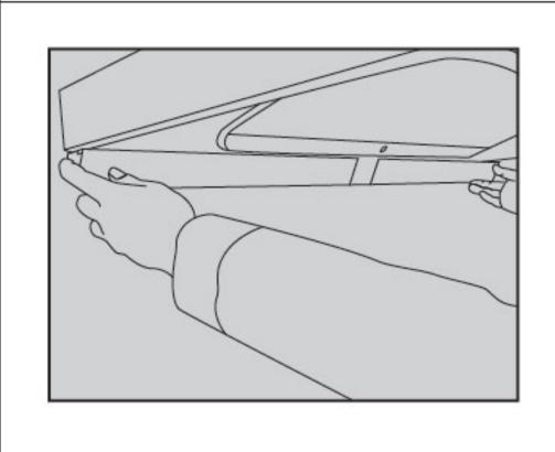
6.雙手握住油杯兩端 使其保持水平狀態, 然后緩慢將其從吸油 烟機前端旋出,取下 油杯后倒出積油。
