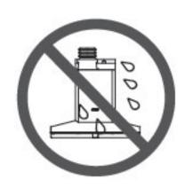
所有電子元件(包括電機、開關和接頭等)均需遠離水源。 請勿用水直接擦洗吸油烟機。請勿使用處于濕潤狀態的吸油 烟機,以免觸電。
