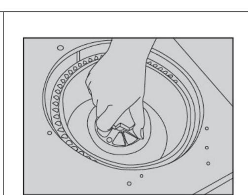
12.沿順時針方向旋出 鎖緊螺母,然后取 下葉輪。
