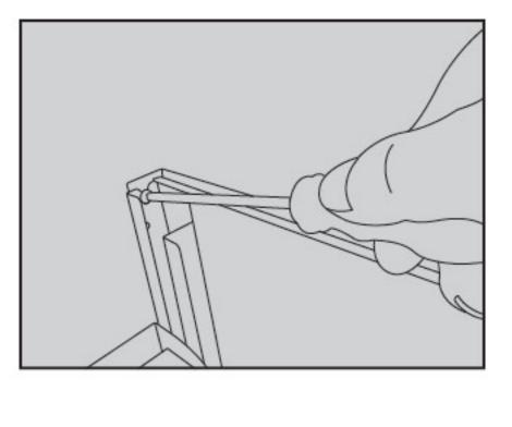
8.用十字螺絲刀旋出固 定風機外罩的兩顆螺 釘,然后取下風機外 罩和裝飾罩。
