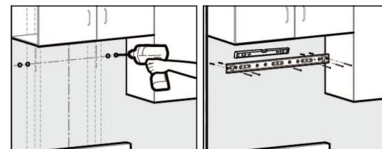
**Attention:** Au moins une des vis du crochet de l'appareil principal doit être fixée sur la poutre en bois. Il faut mettre les vis de fixation dans les trous A et B illustrés dans la figure. La partie de la position du trou de crochet dans la zone C, qui est correspondante au pieu, doit être équipée des vis de fixation.
