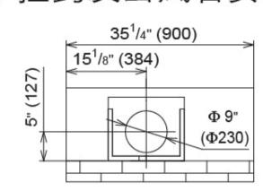
出風管走吊頂安裝示意圖
